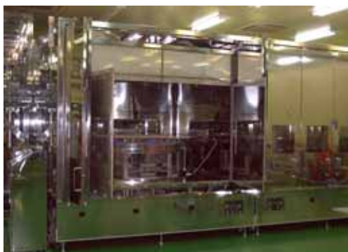
図7 「第6世代ガラス基板（1800mm*1500mm）」に対応する液晶スペーサ散布装置、ディスパ・ミューR『G6シリーズ』の写真
